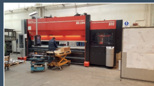
Pressopiegatrice da 220 tonnellate e 4 metri di lunghezza con cambio stampi automatico.
