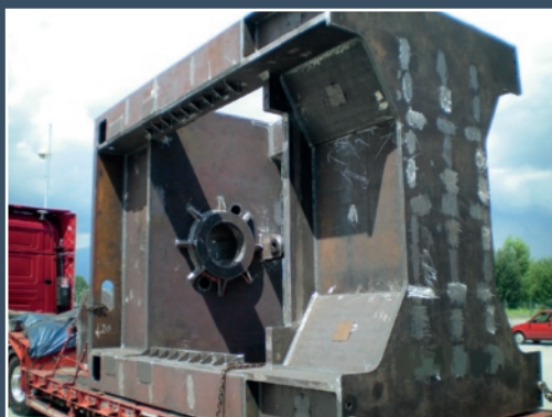
Struttura per pressa.
