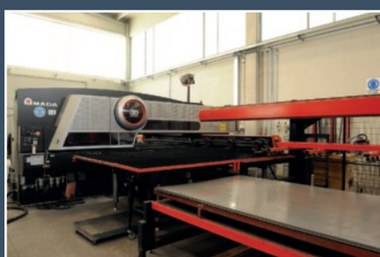
Combinata laser/punzonatrice con carico-scarico automatico.
