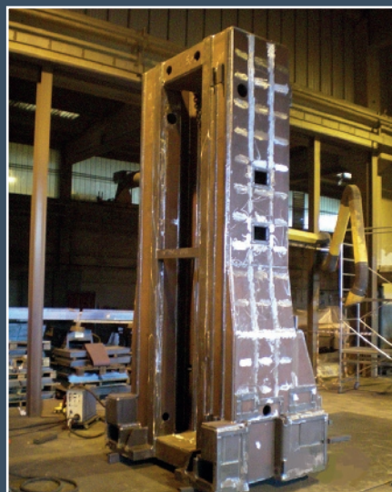
Struttura montante di una alesatrice.
