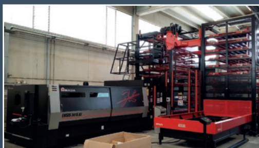
Impianto di taglio laser a fibra da 2.000 Watt con doppia torre di magazzino lamiera.
