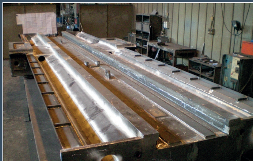
Basamento per macchina utensile (foratrice).
