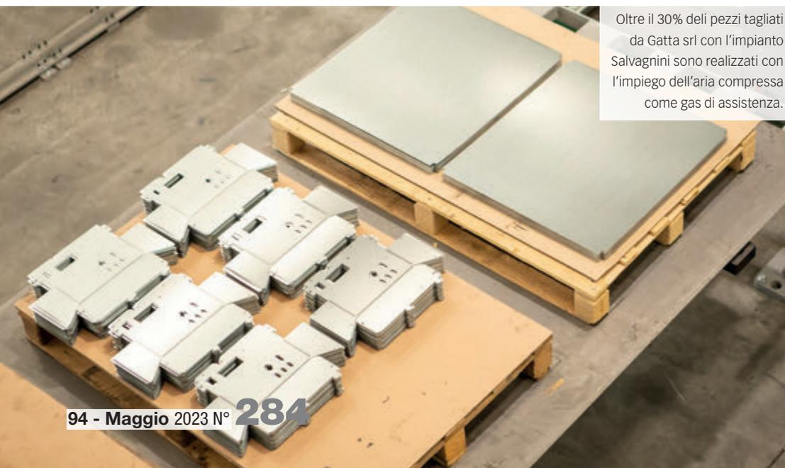
Oltre il 30% dei pezzi tagliati da Gatta srl con l'impianto Salvagnini sono realizzati con l'impiego dell'aria compressa come gas di assistenza.
