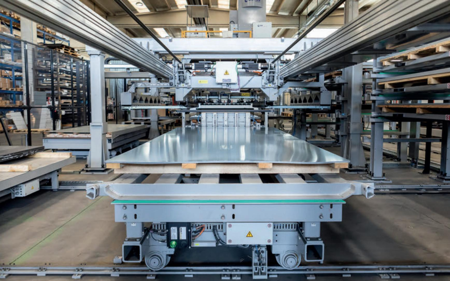
L'automazione con diversi mini-tower a vassoi permette la possibilità di re-immagazzinare di nuovo i pezzi tagliati senza interrompere il processo.
