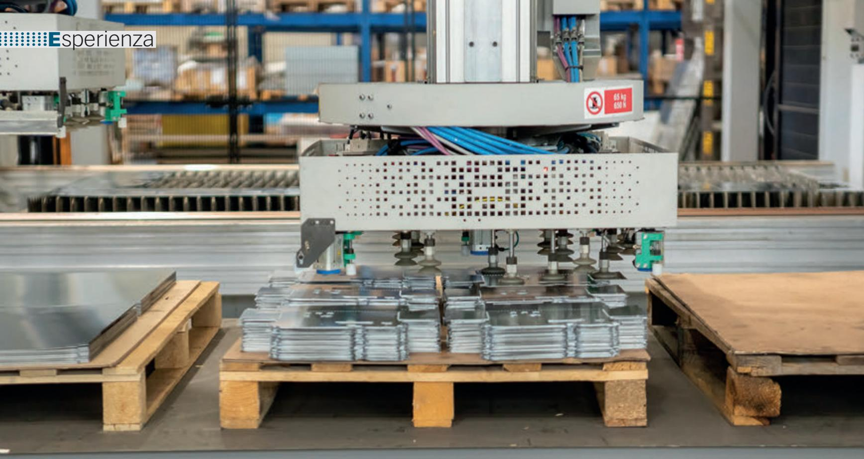
L'impianto di taglio è dotato di sistema MCU per il sorting automatico su due baie di scarico.
